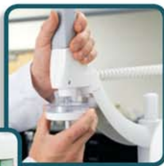
Замена финишного фильтра Millipak Express 40
