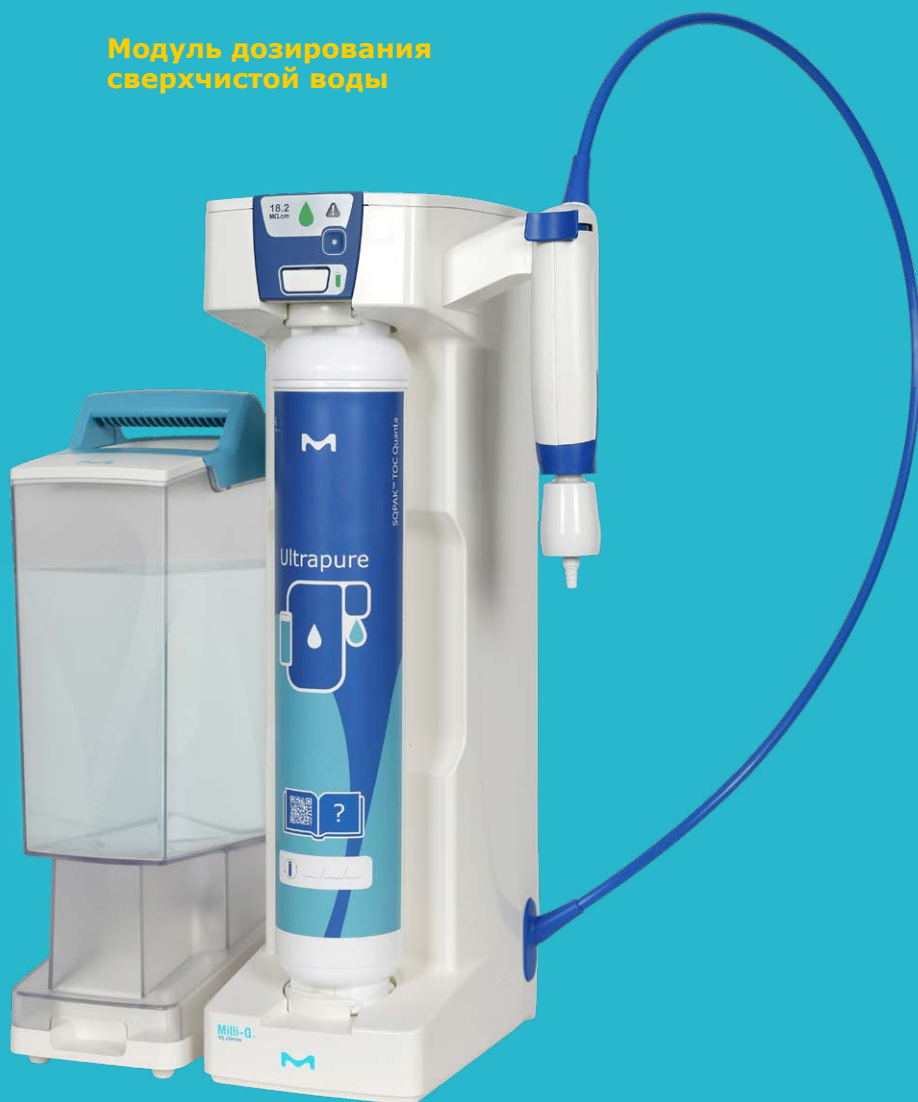
SQPAK™ Финишный фильтр Удаляет частицы и бактерии
