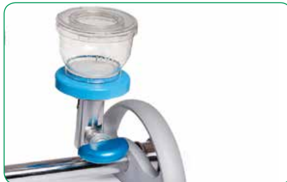
Устройство EZ-Fit™ идеально устанавливается на гребенку
